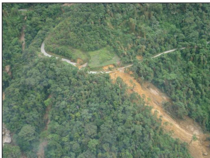
Figura IV.7-4: Trecho da Estrada Paraty-Cunha destruído por deslizamentos ocorridos no alto da Serra da Bocaina (Paraty, jan. de 2009. Fotografia cedida pela Defesa Civil Municipal de Paraty)
